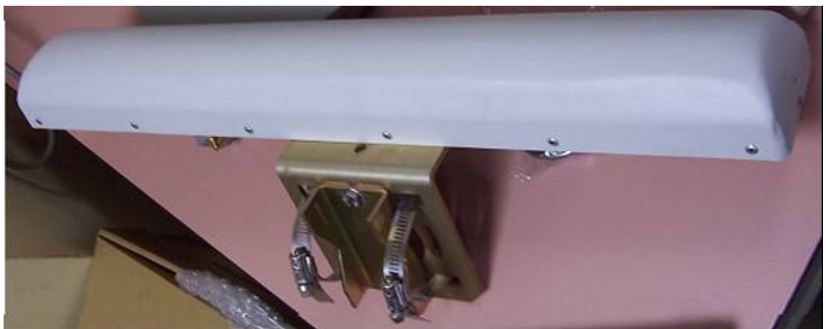
Anclajes antena sectorial
